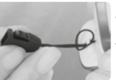
Vous pouvez fixer une lanière à l'appareil pour faciliter le transport de l'oxymètre de pouls. Faites glisser l'extrémité fine de la lanière à travers le support comme sur l'illustration. Tirez fermement l'autre extrémité de la lanière à travers le passant de l'extrémité fine.
